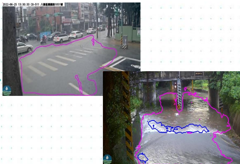
依據影像辨識啟動條件， 進行道路積淹水影像辨識
