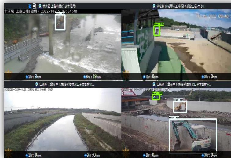
依據影像辨識啟動條件， 進行人員及機具影像辨識
